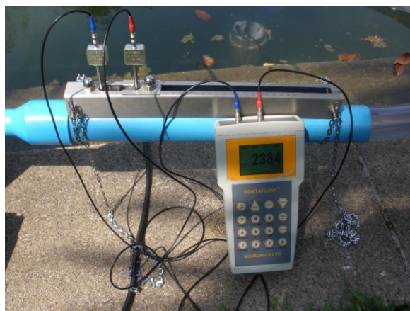
ภาพที่ 4.3 ค่าอัตราการไหลทางด้านน้ำเข้ากังหัน เมื่อมีการต่อโหลด
