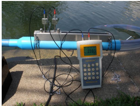
ภาพที่ 4.2 ค่าอัตราการไหลทางด้านน้ำเข้ากังหัน เมื่อไม่มีการต่อโหลด
