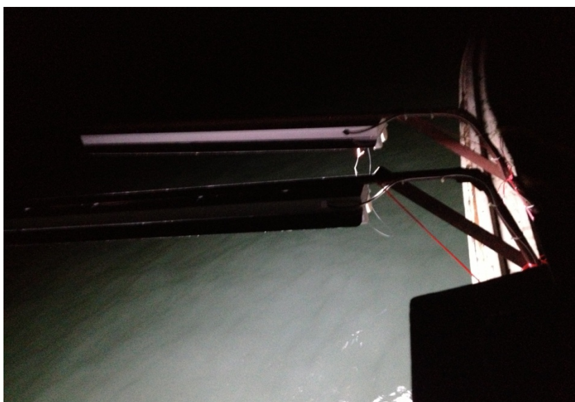
ภาพที่ 3.11 ติดตั้งโคมหลอด LED จำนวน 2 โคมแล้วบันทึกจำนวนปลาหมึกในตารางที่ 3.8
