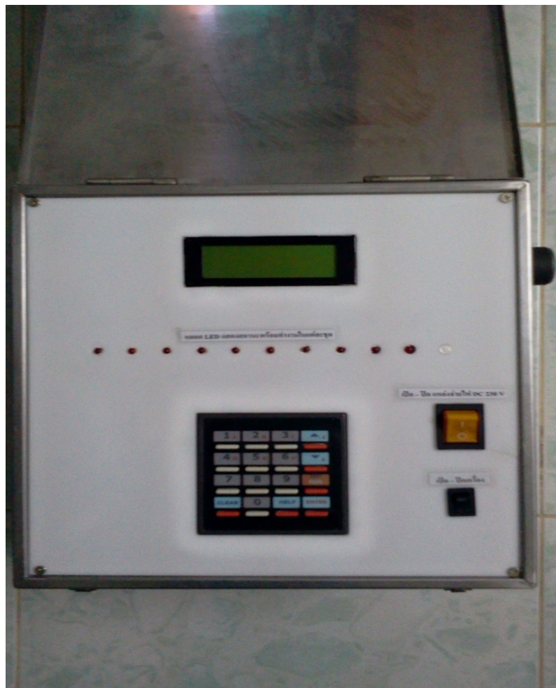
ภาพที่ 3.16 ด้านบนของเครื่องควบคุมการตั้งเวลาสำหรับระเบิดหิน
