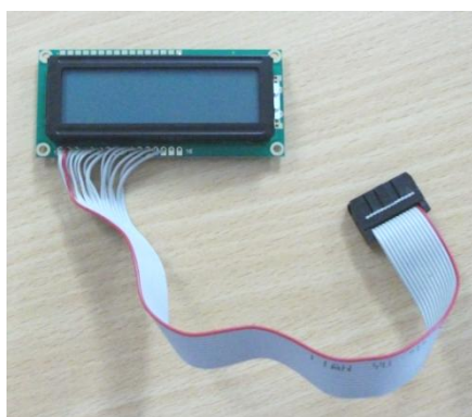
ภาพที่ 2.8 จอแสดงผลแบบ LCD ขนาด 16 ตัวอักษร 2 บรรทัด
