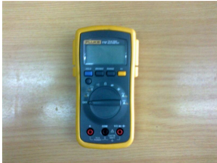
Fluke Multimeter : Range Max 600Vrms , Max 10A
