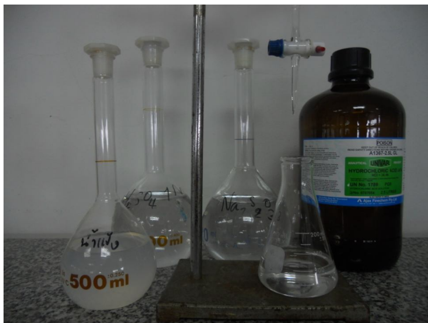
ภาพที่ 2.16 อุปกรณ์และสารเคมีสำหรับการตรวจวัดปริมาณ ไอโอดีนด้วยวิธี Iodometric method
