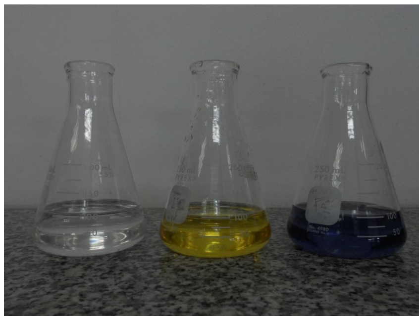
ภาพที่ 2.17 สีของสารละลายโปแตสเซียมไอโอไดด์ ก่อน-หลังทำปฏิกิริยา และ หลังเติมกรดซัลฟูริก กับ น้ำแป้ง
