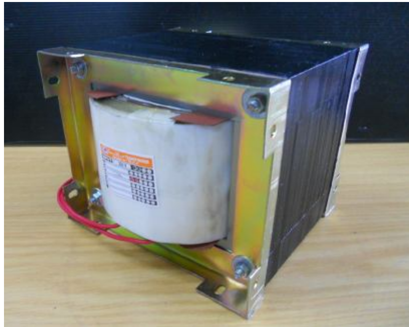
ภาพที่ 3.9 หม้อแปลงไฟฟ้า ที่ได้จากการคำนวณเพื่อใช้ในการวิจัย
