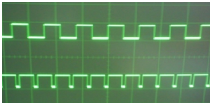
ภาพที่ 4.2 รูปคลื่นสัญญาณพัลส์วิทมอดูเลต ขนาด 80%
