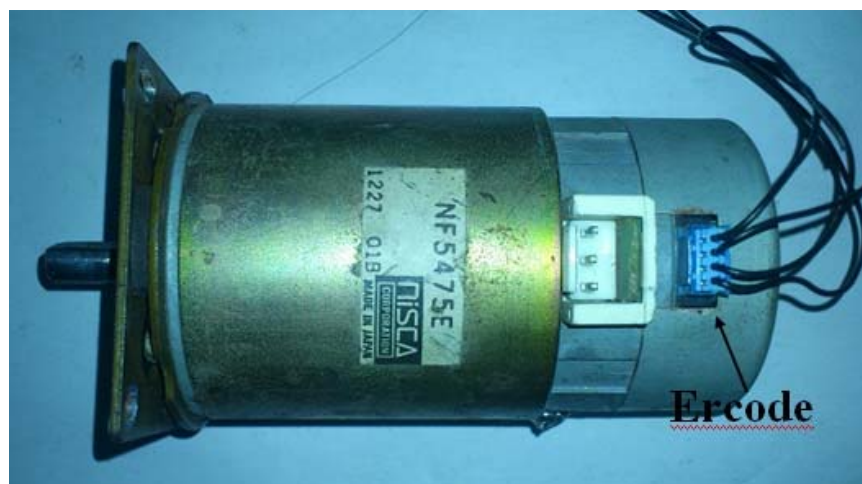
ภาพที่ 3.3 ชุดวัดการหมุนมอเตอร์ (Encode)
