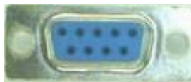
ภาพที่ 2.14 พอร์ตต่ออนุกรม RS-232 ตัวเมีย
