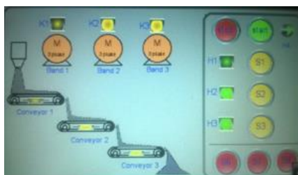
ภาพที่ 4.12 หน้าจอทัชสกรีน การทำงานของสายพานลำเลียงที่ 2 และ 3
