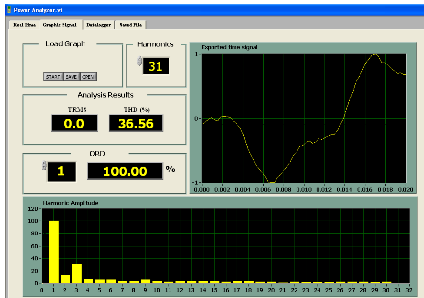
ภาพที่ 4.14 กระแส THD_{i2} โดยต่อผ่านหม้อแปลงชุกแซกแบบที่ 2 Dz6
