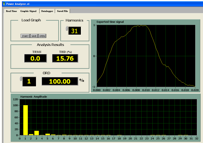
ภาพที่ 4.7 กระแส THD_{i1} โดยต่อผ่านหม้อแปลงชิกแซกแบบที่ 1 Dz0
