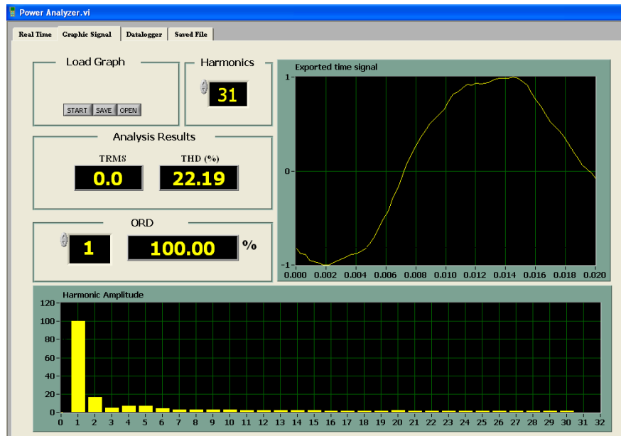
ภาพที่ 4.21 กระแส THD_{i3} โดยต่อผ่านหม้อแปลงชุกแซกแบบที่ 3 Yz1
