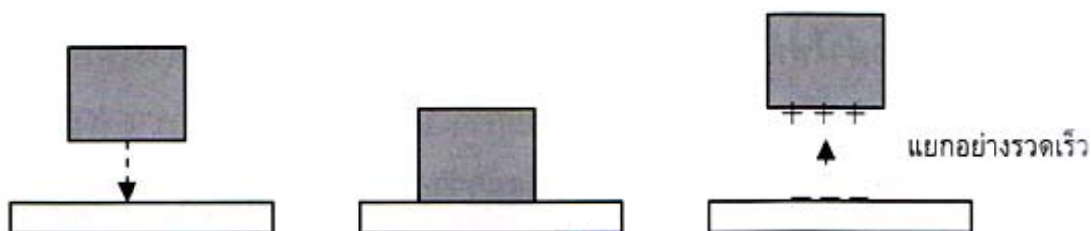
ภาพที่ 2.1 แสดงแบบจำลองการเกิดทริโบอิเล็กทริกของวัสดุ 2 ชนิด
