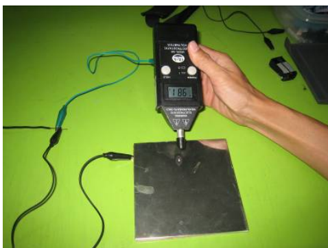
ภาพที่ 4.8 แสดงประจุไฟฟ้าที่เกิดจากการเคลื่อนไหวนของผู้ที่ทำการทดลองโดยสะสมอยู่บนแผ่นเก็บประจุ
