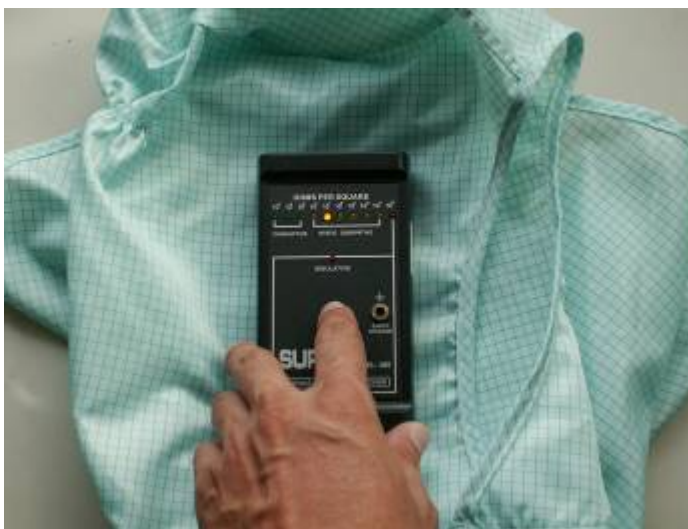
ภาพที่ 2.9 ภาพแสดงค่าความต้านทานที่วัดได้จากชุด Cleanroom ที่ทำจากวัสดุที่กระจายประจุ (Dissipative material)
