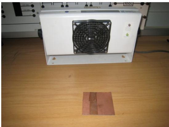
ภาพที่ 2.14 เครื่องสร้างประจุ ( Ionizer )
