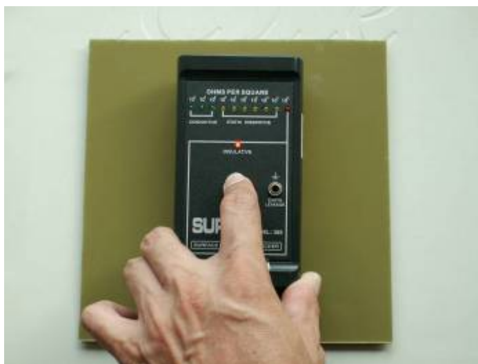
ภาพที่ 2.8 แสดงค่าที่อ่านได้จากวัสดุที่เป็นฉนวนจากเครื่องวัดค่าความต้านทาน (Resistance meter)
