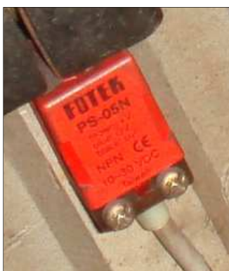
ภาพที่ 3.6 พร็อกซิมีตี้เซนเซอร์ (Proximity Sensor)
