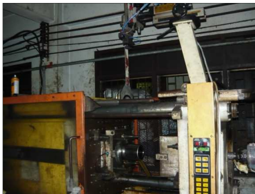
ภาพที่ 4.3 แสดงการติดตั้งชุดแขนกลเข้ากับเครื่องฉีดขึ้นงานโพลพลาสติก
