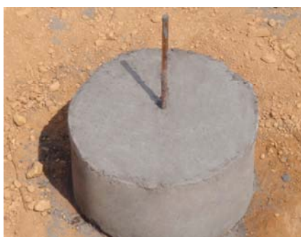
ภาพที่ 4.2 แสดงการหล่อตัวลวดความต้านทานห่อหุ้มบริเวณตรงกลางของแท่งตัวนำ
