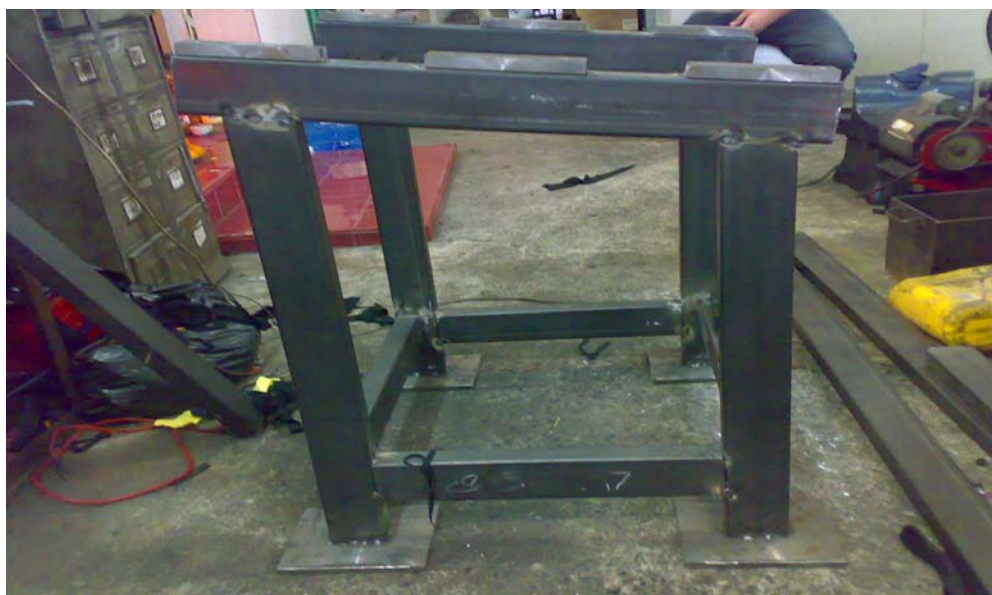
ภาพผนวกที่ 2 โครงสร้างเครื่องรีดแผ่นยางพารามองทางด้านข้าง
