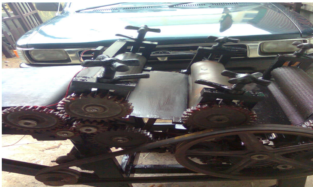
ภาพผนวกที่ 5 ชุดเฟืองและมู่เล่ของชุดส่งกำลัง
