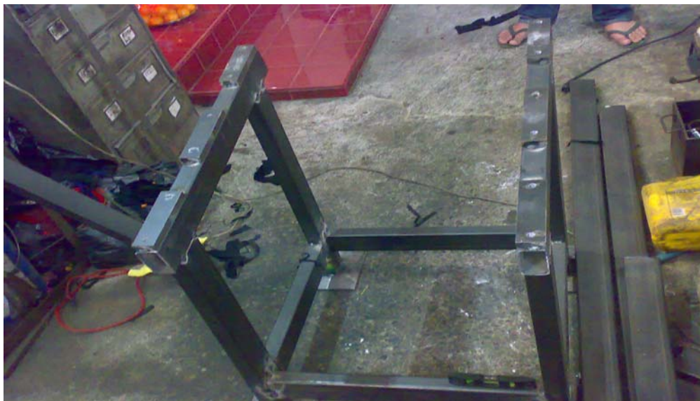
ภาพผนวกที่ 1 โครงสร้างเครื่องรีดแผ่นยางพารามองทางด้านบน
