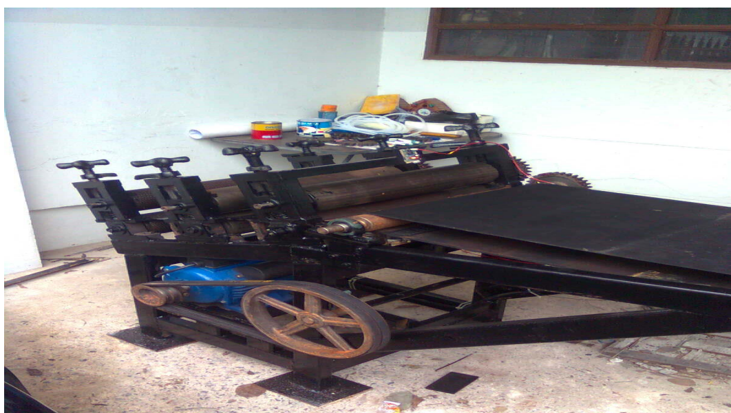
ภาพผนวกที่ 4 เครื่องรีดแผ่นพาราแบบกึ่งอัตโนมัติตอนประกอบเรียบร้อยแล้ว
