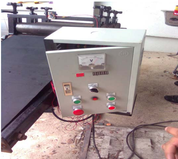
ภาพผนวกที่ 7 ตู้ควบคุมเครื่องรีดแผ่นยางพารา
