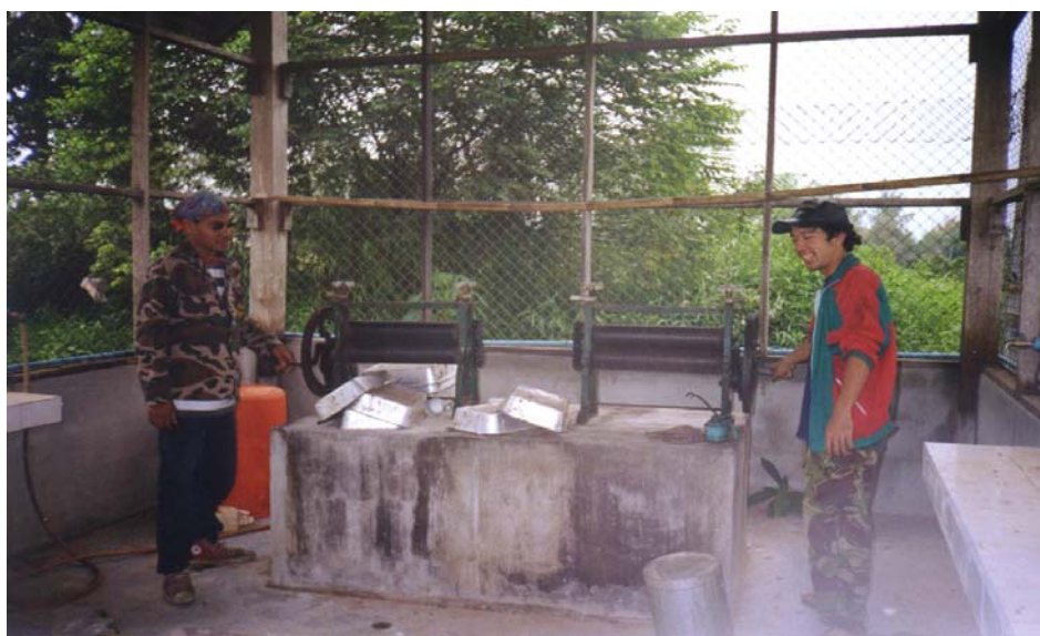
ภาพที่ 2.1 ภาพแสดงเครื่องรีดยางที่เกษตรกรใช้กัน
