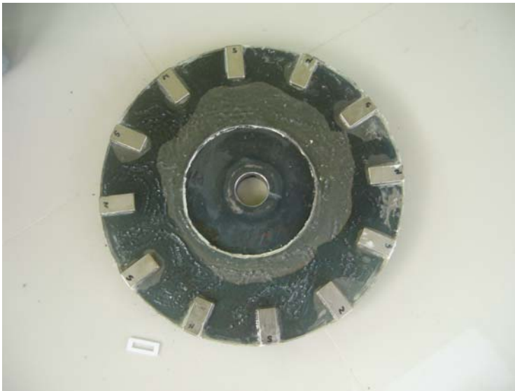
ภาพที่ 3.7 การติดตั้งขั้วแม่เหล็กบนจานโรเตอร์
