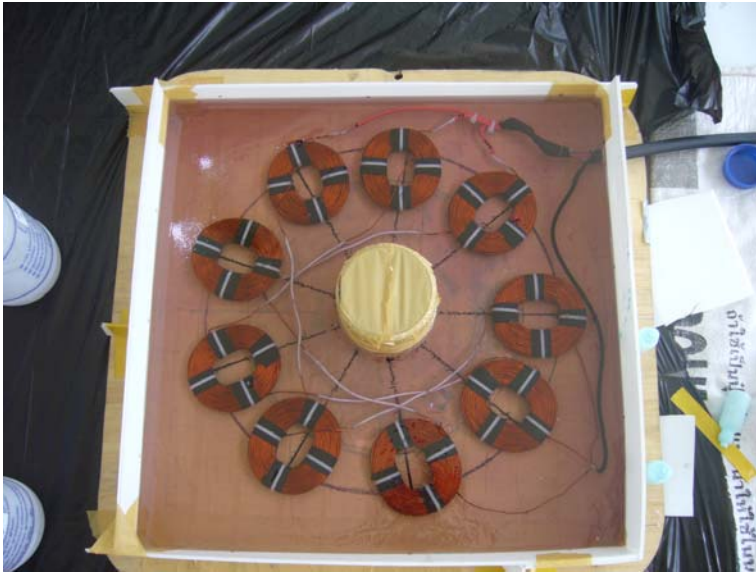
ภาพที่ 3.15 ตัวอยู่กับที่ของเครื่องกำเนิดไฟฟ้าหลังเทเรซีน
