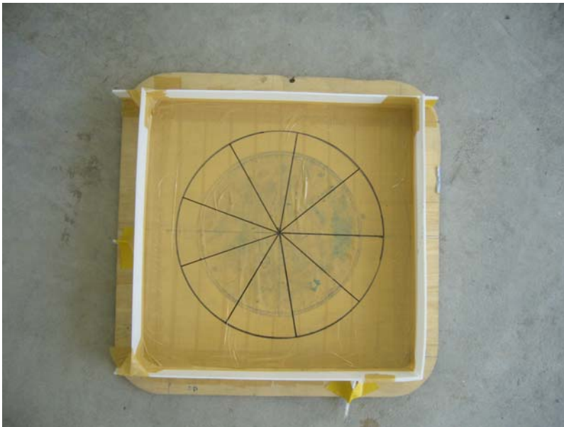
ภาพที่ 3.12 แบบพิมพ์ตัวอยู่กับที่ของเครื่องกำเนิดไฟฟ้าสำหรับหล่อเรซิน
