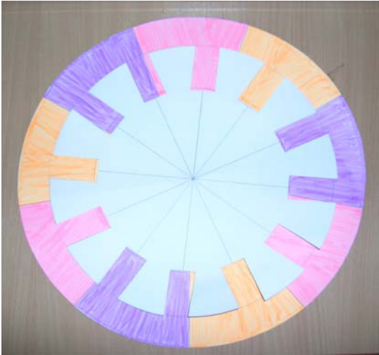
ภาพที่ 3.6 ทำแบบจำลองใช้ในการติดตั้งขั้วแม่เหล็ก
