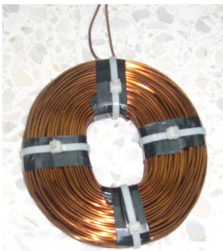
ภาพที่ 3.10 คอลย์ขดลวดทองแดงที่ได้จากการพันด้วยฟอรั่มคอยล์
