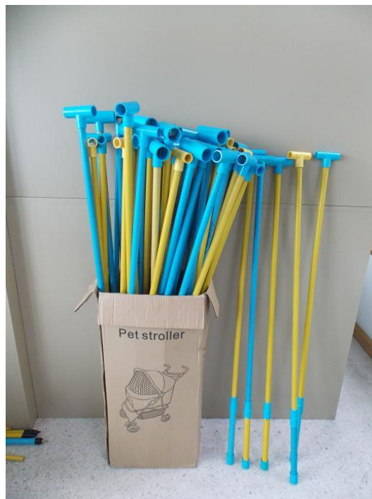
ภาพที่ 3.11 แสดงอุปกรณ์ตรวจสอบกระแสไฟฟ้าวูที่ได้รับการประกอบกับท่อพีวีซี
