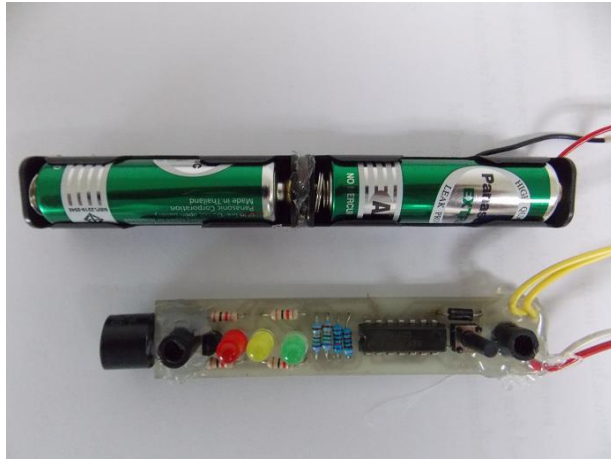
ภาพที่ 3.10 แสดงอุปกรณ์ตรวจสอบกระแสไฟฟ้าวูที่ที่ได้รับการพัฒนา
