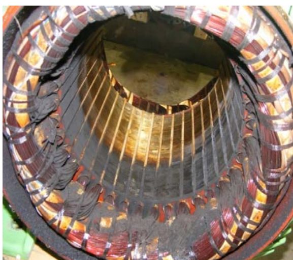
ภาพที่ 2.6 การเสียหายของขดลวดสเตเตอร์
