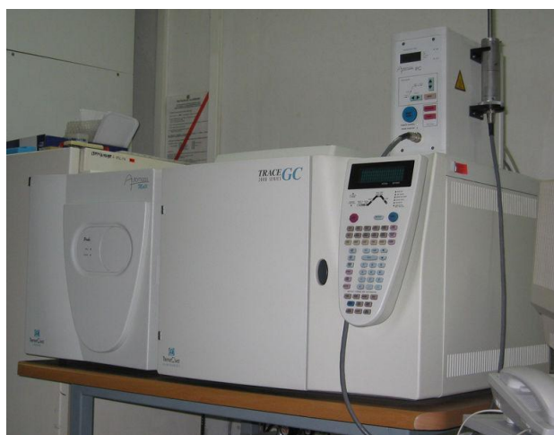
ภาพที่ 2.7 GC / MS ที่ใช้สำหรับการวัดสาร furanic (TACS)
