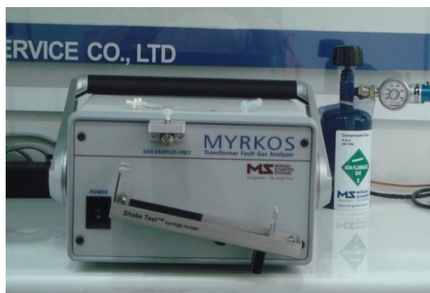
ภาพที่ 2.1 MYRKOS Transformer Fault Gas Analyzer ตรวจสอบหาก๊าซ
