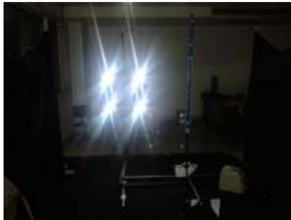
ภาพที่ 4.4 การตั้งตัวรับสัญญาณที่จุดต่างๆบริเวณหลอด LED
