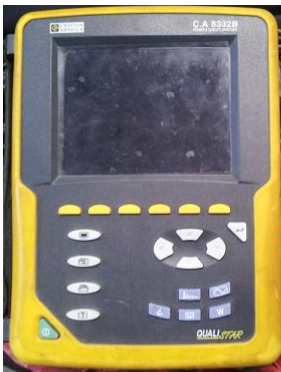
ภาพที่ 3.6 เครื่องมือที่ใช้วัดคุณภาพไฟฟ้า
