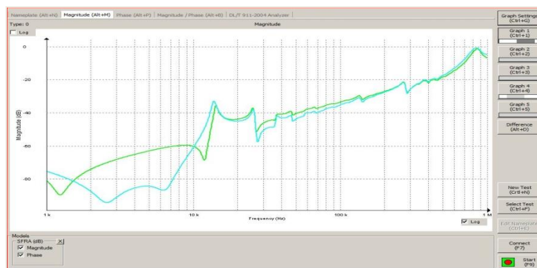
ภาพที่ 2.15 การตอบสนองความถี่ของหม้อแปลงก่อนการบำรุงรักษา
