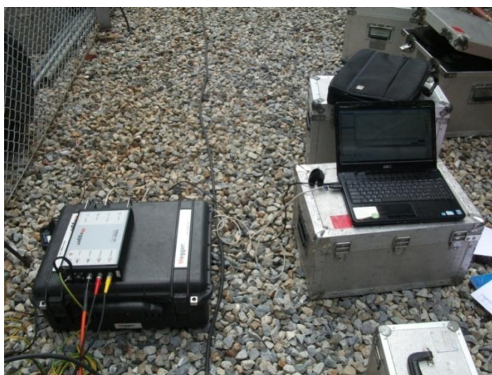
ภาพที่ 4.3 วิธีการเชื่อมต่อเครื่องทดสอบ FRAX - 101 ทางด้านเครื่องจ่ายสัญญาณความถี่
