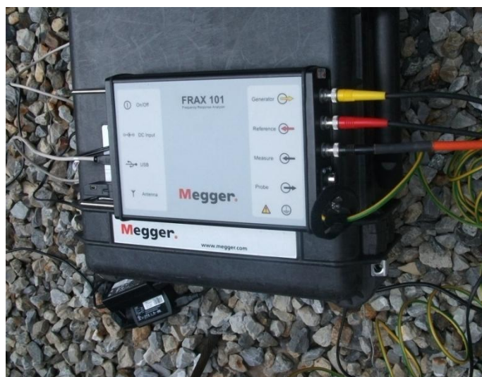
ภาพที่ 4.2 ขั้วการเชื่อมต่อของเครื่อง FRAX - 101
