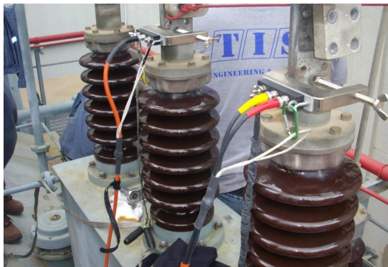
ภาพที่ 4.4 วิธีการเชื่อมต่อสายสัญญาณจากเครื่อง FRAX – 101 กับขั้วของหม้อแปลงที่ต้องการทดสอบ
