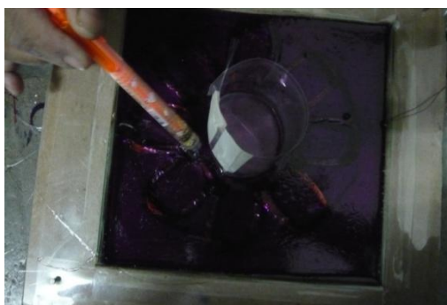
ภาพที่ 3.10 การทำแผ่นขอบโรเตอร์และการเทเรซินลงบนแผ่นโรเตอร์
