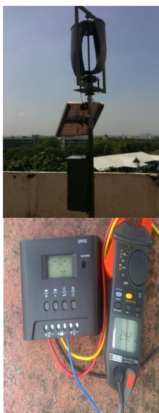
ภาพที่ 4.3 การทดลองการเก็บประจุและการจ่ายพลังงานของโซล่าเซลล์
