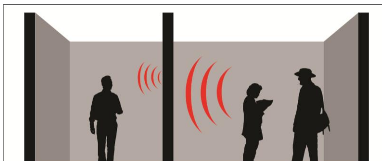
รูปที่ 4.6 แสดงการป้องกันเสียง เป็นการลดพลังงานเสียงที่ส่งผ่านจากห้องหนึ่งไปยังอีกห้องหนึ่ง
