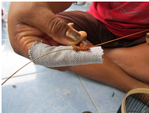
ภาพที่ 2.86 แสดงการใช้มีดขูดเส้นลิเภาให้บางและเรียบเสมอกันทั้งเส้น
