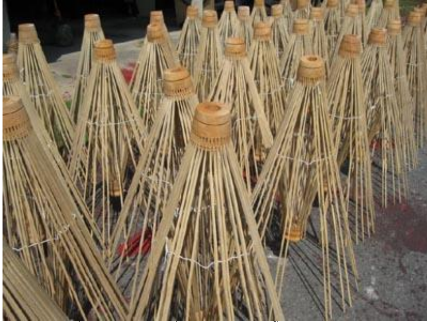
ภาพที่ 2.21 กลไกของร่มที่ส่่าใช้ฝีมือในการทำทั้งหมดตามกระบวนการ ที่มา http://www.holidaythai.com/thailand
