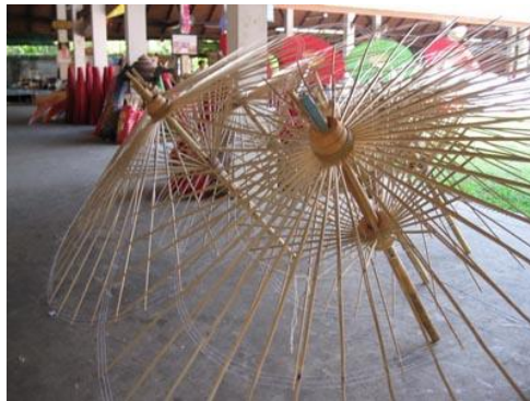
ภาพที่ 2.21 กลไกของร่มที่ส่่าใช้ฝีมือในการทำทั้งหมดตามกระบวนการ ที่มา http://www.holidaythai.com/thailand
