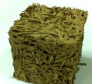
สูตรที่ 6 ดินเหนียว 1 ส่วน ต่อ แกลบ 4 ส่วน หตควัร้อยละ 0.2 / น้ำหนัก 765.84 กก. ต่อ ลบ.ม.
