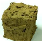
สูตรที่ 10 ดินเหนียว 1 ส่วน ต่อ ฟาง 2 ส่วน หตควัร้อยละ 8.3 / น้ำหนัก 872.22 กก. ต่อ ลบ.ม.
