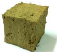
สูตรที่ 2 ดินเหนียว 2 ส่วน ต่อ แกลบ 1 ส่วน หตควัร้อยละ 32.9 / น้ำหนัก 1525.40 กก. ต่อ ลบ.ม.
