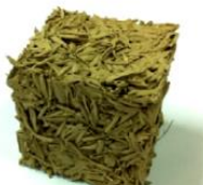
สูตรที่ 5 ดินเหนียว 1 ส่วน ต่อ แกลบ 3 ส่วน หตควัร้อยละ 2.1 / น้ำหนัก 817.53 กก. ต่อ ลบ.ม.
