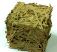
สูตรที่ 11 ดินเหนียว 1 ส่วน ต่อ ฟาง 3 ส่วน หตควัร้อยละ 1.5 / น้ำหนัก 636.13 กก. ต่อ ลบ.ม.
