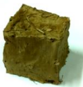
สูตรที่ 7 ดินเหนียว 3 ส่วน ต่อ ฟาง 1 ส่วน หตควัร้อยละ 37.9 / น้ำหนัก 1652.97 กก. ต่อ ลบ.ม.
