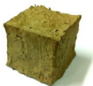
สูตรที่ 1 ดินเหนียว 3 ส่วน ต่อ แกลบ 1 ส่วน หตควัร้อยละ 36.9 / น้ำหนัก 1784.17 กก. ต่อ ลบ.ม.
