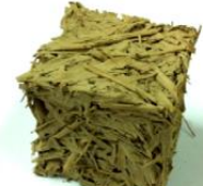
สูตรที่ 12 ดินเหนียว 1 ส่วน ต่อ ฟาง 4 ส่วน หตควัร้อยละ 0.2 / น้ำหนัก 522.61 กก. ต่อ ลบ.ม.
