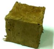
สูตรที่ 8 ดินเหนียว 2 ส่วน ต่อ ฟาง 1 ส่วน หตควัร้อยละ 34.1 / น้ำหนัก 1493.27 กก. ต่อ ลบ.ม.
