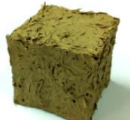
สูตรที่ 3 ดินเหนียว 1 ส่วน ต่อ แกลบ 1 ส่วน หตควัร้อยละ 16.4 / น้ำหนัก 1182.84 กก. ต่อ ลบ.ม.
