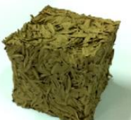
สูตรที่ 4 ดินเหนียว 1 ส่วน ต่อ แกลบ 2 ส่วน หตควัร้อยละ 7.7 / น้ำหนัก 996.89 กก. ต่อ ลบ.ม.
