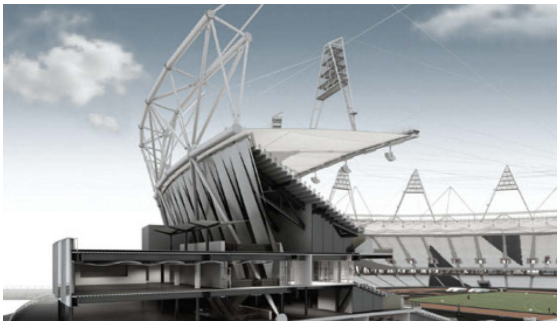
ภาพที่ 3.5 ตัวอย่างภาพโครงสร้างแบบผสม Combined structures, Mixed structures
