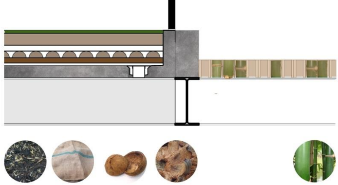
ภาพที่ 68 แสดงแบบขยายหลังคาเขียว
