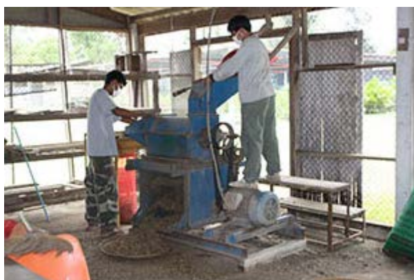
รูปที่ 2.6 รูปภาพแสดงการคัดแยกเมล็ดไม้ออกจากผล / ฝักแห้งด้วยเครื่องจักร
