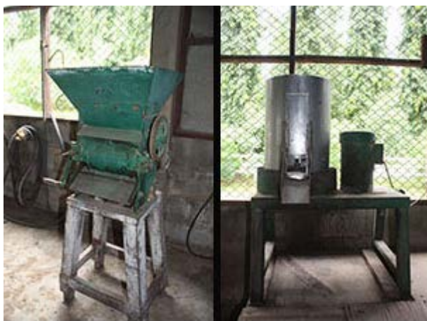
รูปที่ 2.5 รูปภาพแสดงการคัดแยกเมล็ดไม้ออกจากผลสดด้วยเครื่องจักร
