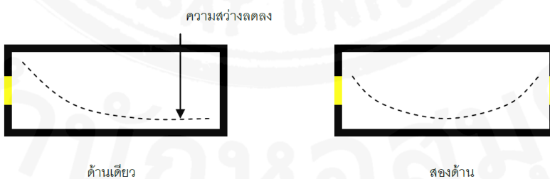
รูปที่ 2.77 การเปรียบเทียบการเปิดช่องเปิดด้านเดียวและสองด้าน ที่มา http://resource.thaihealth.or.th/
