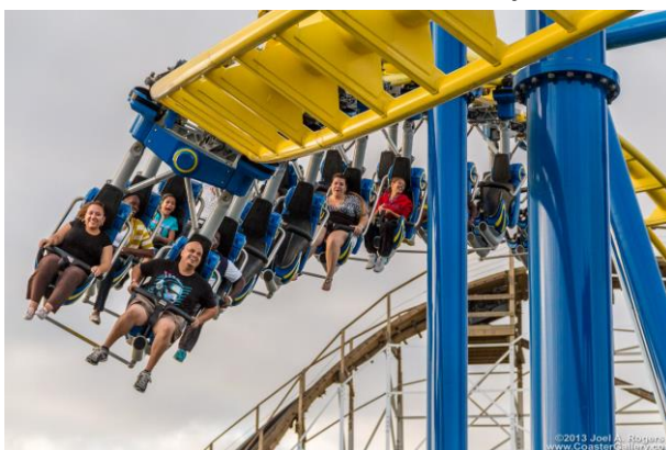
ตัวอย่างรถไฟเหาะแบบที่นั่งแขวนอยู่ใต้ราง 16
