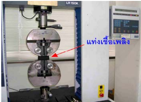
รูปที่ 3 การทดสอบแรงกดแท่งเชื้อเพลิงโดย UTM
