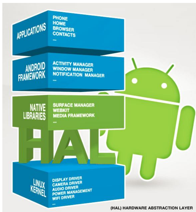
ภาพประกอบที่ 2.26 ภาพลำดับชั้นของ Android Architecture (1)
