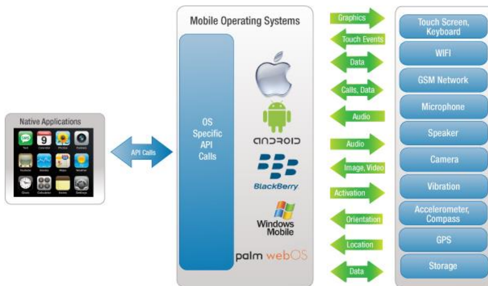
ภาพประกอบที่ 2.2 Native Application Interaction with Mobile Device (ที่มา : XRG, 2015)
