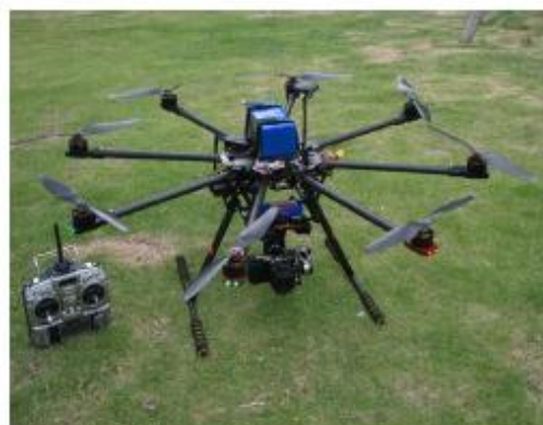
ภาพที่ 2.2 อากาศยานไร้คนขับที่มีลักษณะปีกแข็ง ภาพที่ 2.3 อากาศยานไร้คนขับที่มีลักษณะปีกหมุน
