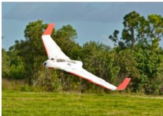
ภาพที่ 2.2 อากาศยานไร้คนขับที่มีลักษณะปีกแข็ง ภาพที่ 2.3 อากาศยานไร้คนขับที่มีลักษณะปีกหมุน
