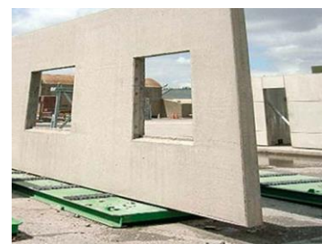
รูปที่ 3.3 วัสดุคอนกรีตหล่อสำเร็จ
