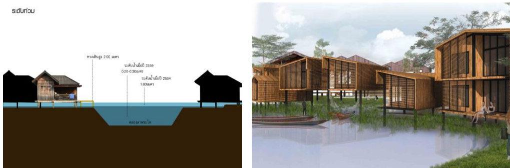
รูปภาพที่ 5.4.ภาพแสดงระดับน้ำและผลการออกแบบส่วนที่พักเพื่อรองรับน้ำท่วม
