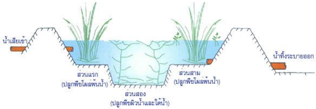
รูปที่ 4.14 ภาพแสดงระบบการทำงานของระบบบำบัดน้ำเสียแบบบึงประดิษฐ์
