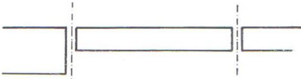
ภาพที่ 2.2 รอยต่อของชิ้นส่วนผนังกับกำแพงก่ออิฐ
