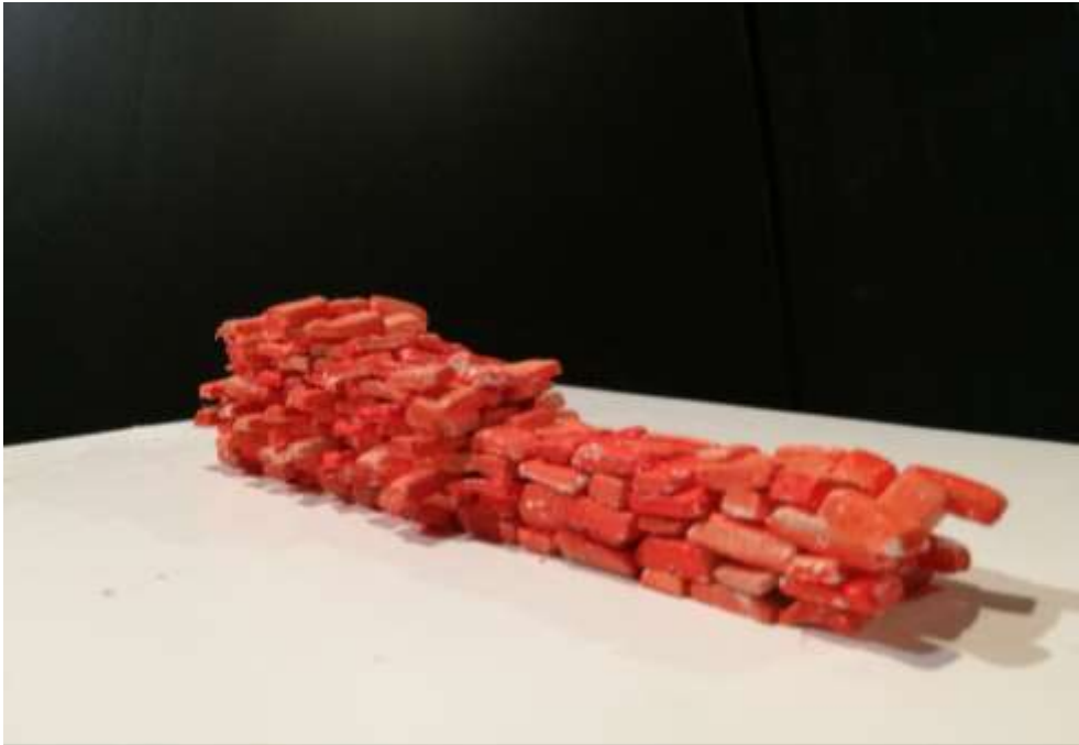
รูปภาพที่ 4.93 หุ่นจำลองแบบขยายการเรียงอิฐ
