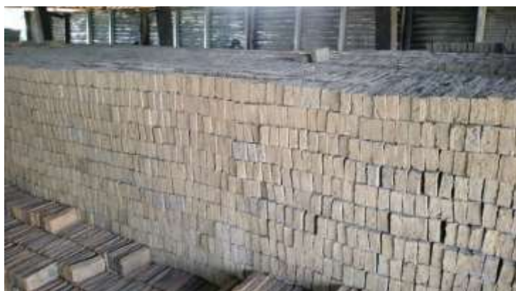
รูปภาพที่ 2.241 การพักอิฐเพื่อรอการเผา
