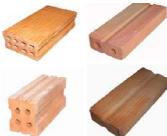
รูปภาพที่ 2.28 อิฐมอญที่ใช้เครื่องในการผลิต ที่มา https://www.novabizz.com/uploads/post/16844-1.jpg
