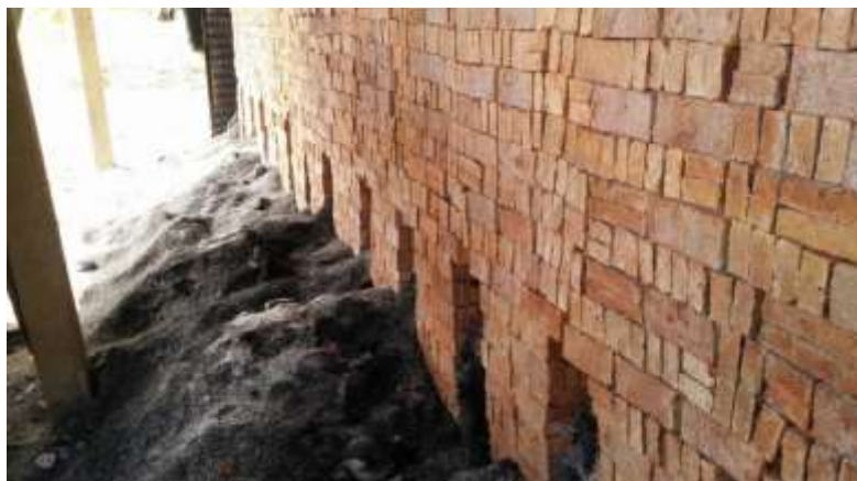
รูปภาพที่ 2.27 การพักอิฐเมื่อทำการเผาเสร็จแล้ว
