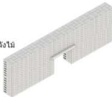
รูปภาพที่ 3.17 โครงสร้างอิฐที่ใช้ทับหลังเป็นไม้
