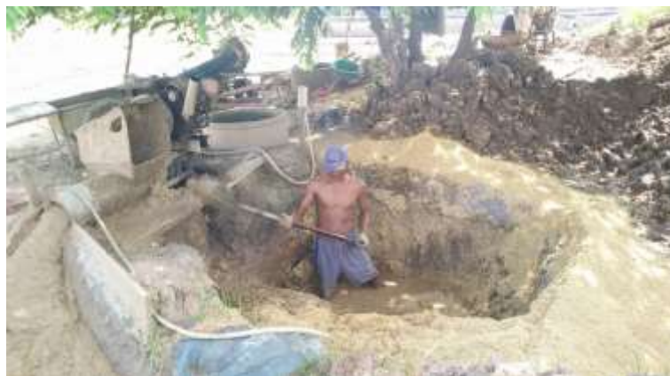
รูปภาพที่ 2.21 การตักดินและกลบเข้าเครื่องบด
