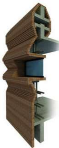
รูปภาพที่ 2.91 เทคนิคแสดงการก่ออิฐหลอกภายนอกแต่ทำการเสริมโครงสร้างภายใน ที่มา http://www.google.com/Brick/detail/facade
