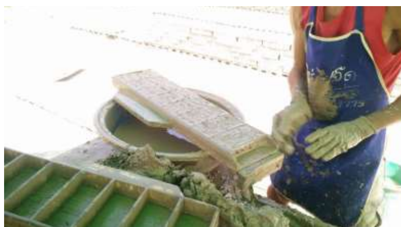
รูปภาพที่ 2.22 การนำดินที่ผสมกลบมาใส่ลงในแม่พิมพ์
