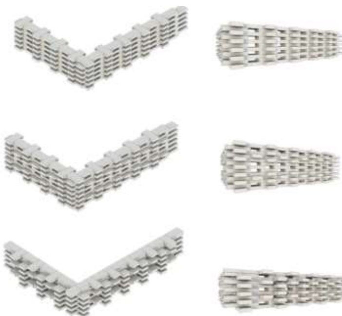
รูปภาพที่ 3.24 การทดลองเรียงอิฐแบบ เฟลมิช บอนด์ โดยเรียงให้เกิดลวดลายเพื่อนประดับตกแต่ง หน้า 25 เซนติเมตร
