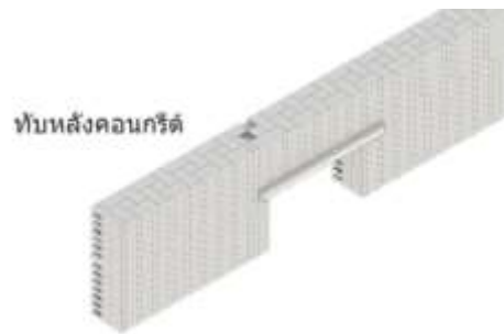
รูปภาพที่ 3.18 โครงสร้างอิฐที่ใช้ทับหลังเป็นคอนกรีต
