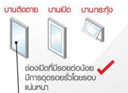
รูปที่ 3. 61 การเลือกใช้หน้าต่าง เพื่อช่วยกันเสียง
