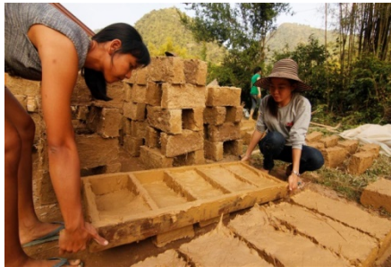
รูปที่ 2.5 การปั้นอิฐดินดิบ (Almhazen, 2017)
