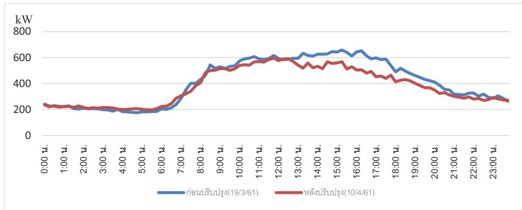
รูปที่ 5 ข้อมูลการใช้พลังงานไฟฟ้า(Load Profile)อาคาร 4 ก่อนและหลังการปรับปรุง
