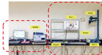
ภาพที่ 5 การทดสอบประสิทธิภาพการทำงานของ PLC ภายในอุณหภูมิสูง
