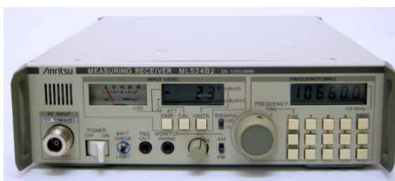
ภาพที่ 2 เครื่องมือวัดวิทยุหือ Anritsu รุ่น ML524B
