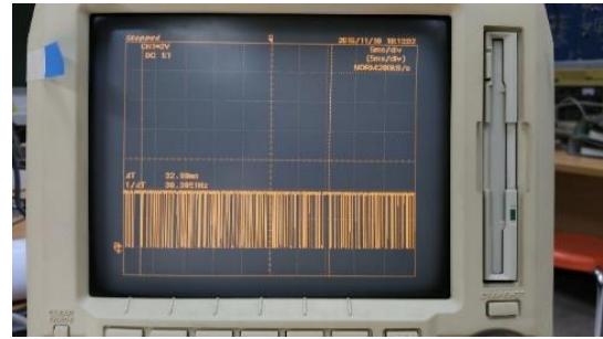
รูปที่ 6 สัญญาณรหัส VLC Id. หลังการเข้ารหัส
