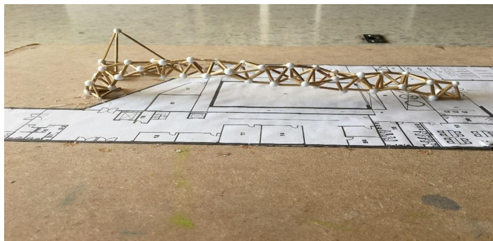
รูปที่ 5. 9 ภาพแสดงแบบร่างทางเลือก 2 โครงสร้างเหล็กแกนกลางแบบถัก 3 มิติ
