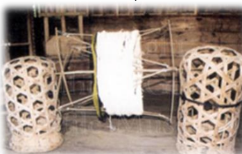
รูปที่ 57 กง (ระวิง) เป็นเครื่องมือที่ใช้สำหรับกรอด้าย
