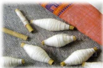
รูปที่ 62 ก้อนหลอด ใช้เสียบ กับเหล็กแหลมของหลา สำหรับปั่นด้ายใส่
