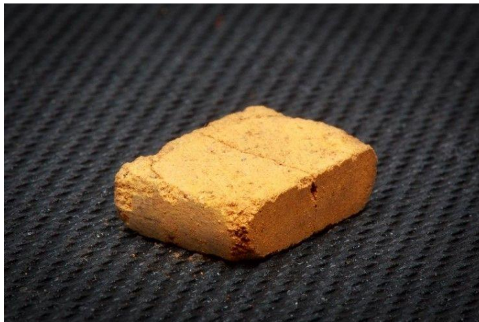
ภาพที่ 50 การทดลองสร้างอิฐจากดินดาวอังคาร
