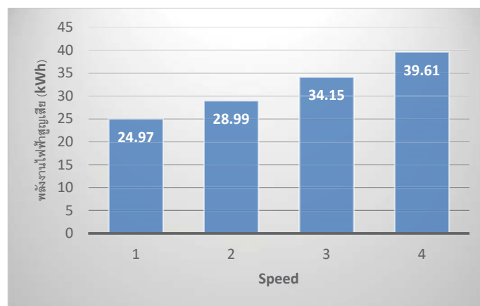
รูปที่ 7 การเปรียบเทียบการสูญเสียพลังงานไฟฟ้าจากการคำนวณการสูญเสียลมเย็นที่ทิ้งออกจากห้อง
