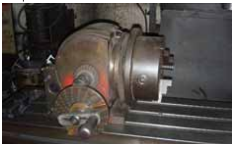
รูปที่ 3 อุปกรณ์นำเจาะและจับงานต้นแบบ
