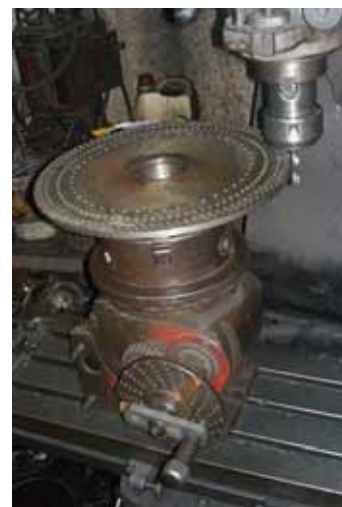
รูปที่ 5 การเจาะงานกำหนดตำแหน่งโดยเครื่องกัดแนวตั้ง
