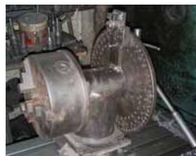
รูปที่ 6 อุปกรณ์นำเจาะและจับชิ้นงานที่ออกแบบ
