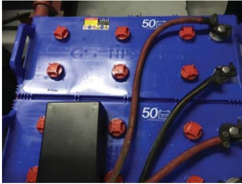
ภาพที่ 7 การติดตั้งและทดสอบชุดจำลองการตรวจวัดแรงดันไฟฟ้าของแบตเตอรี่ผ่านระบบ NETPIE
