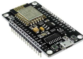
ภาพที่ 2 NodeMCU (ESP8266 Version 2)
